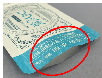
パウチの四辺が圧着されていない
